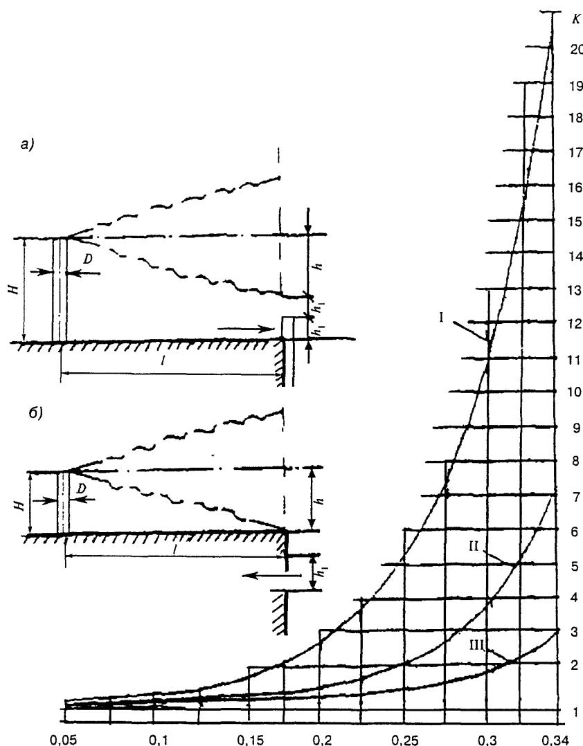
а - расположение источника над зоной всасывания наружного воздуха приемным устройством (высота трубы источника  $H = 2h_l + h$ ); б - то же, над кровлей здания (высота трубы источника  $H = h$ );
